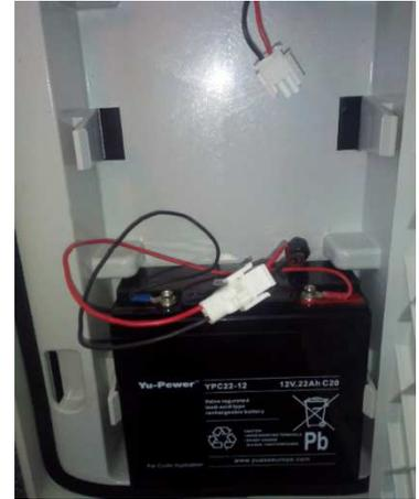
**La autonomía del radar con una batería sola es de 3 a 8 días sin recarga. Depende mucho del tipo de uso. No se debe mover el radar EVOLIS con las baterías dentro por cuestiones de seguridad relacionadas con el peso total del dispositivo.**
