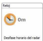
Este icono informa de la diferencia de hora entre el radar y el ordenador. Un clic permite convertir la hora del radar a la hora del ordenador.
