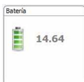
Indicación del nivel de la batería. En caso de batería baja, el ícono cambia de color. Una batería completamente cargada está entre 12.8V y 13.1V.
